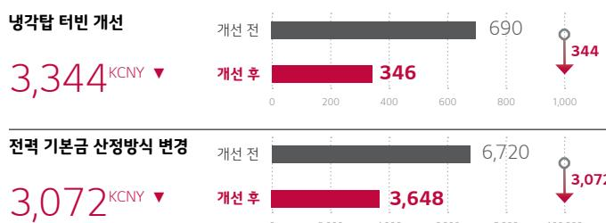
**연태법인**▶ 에너지 절감 투자, 1인 1 프로젝트 운영, 본사 및 타사 벤치마킹 등을 통해 에너지 절감 활동을 적극 추진하였습니다. 특히, 전사 최초로 냉각탑에 무동력 팬을 설치하였을 뿐만 아니라 고효율 설비(건식 PV) 투자, CDA 압력 최적화 등 다양한 활동을 통해 에너지 절감 성과를 달성하였습니다. 이와 더불어 중국의 전력 기본금 정책 변경에 따라 변압기 산정 기준을 변경(용량→최대 사용량)하여 전력 에너지 비용을 절감하였습니다.
