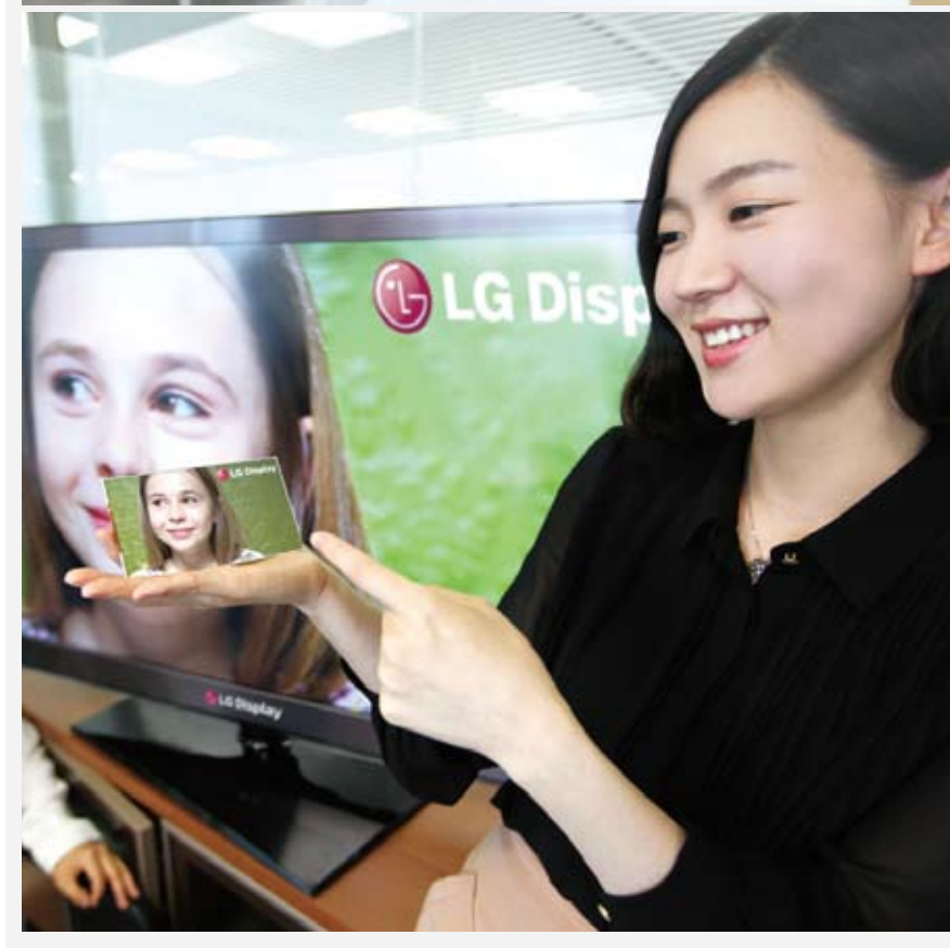
스마트폰용 Full HD LCD • 세계 최초의 Full HD 해상도의 모바일용 AH-IPS LCD 패널 • 1920X1080의 Full HD 해상도에 440ppi가 적용된 세계 최고 해상도 및 최다 픽셀의 LCD • 스마트폰에서도 TV와 마찬가지로 Full HD의 고화질을 즐길 수 있고, 글자도 더욱 선명해져 종이 인쇄물처럼 편리하게 읽기가 가능
