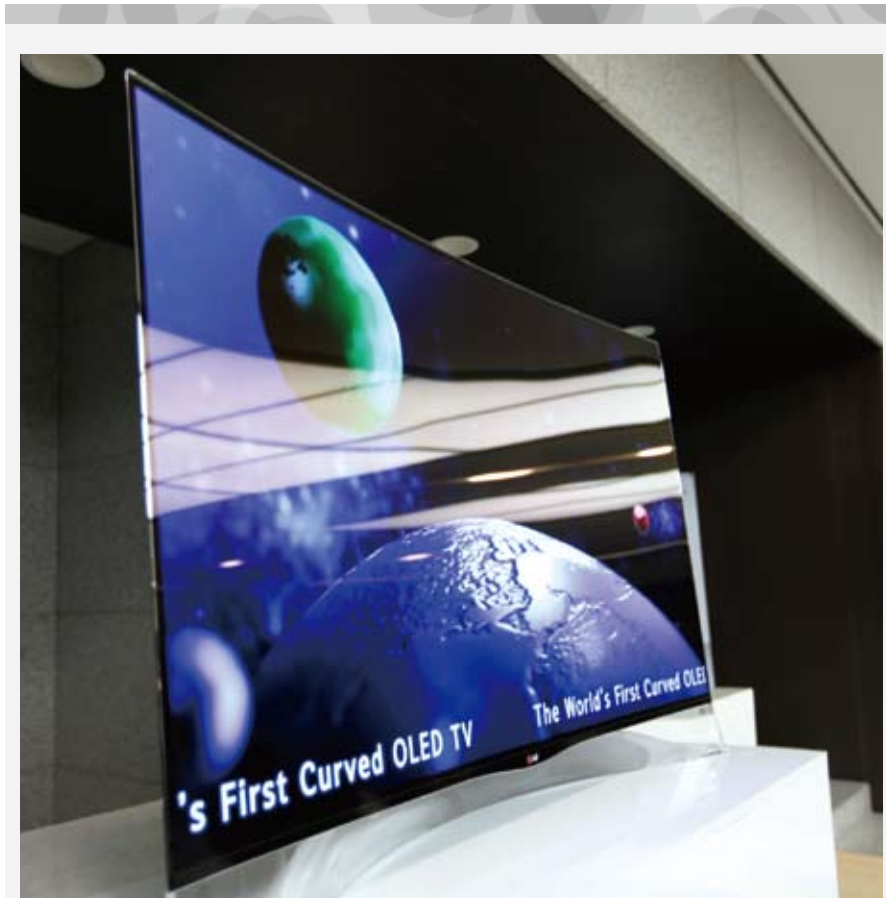
55인치 곡면(Curved) OLED TV • 세계 최초로 양 옆이 오목하게 휘어진 화면 적용 • 시청자의 눈에서부터 화면 중심부와 측면까지의 각 거리를 동일하게 해 화면왜곡 및 '외곽부 인지도 감소 현상'을 최소화
